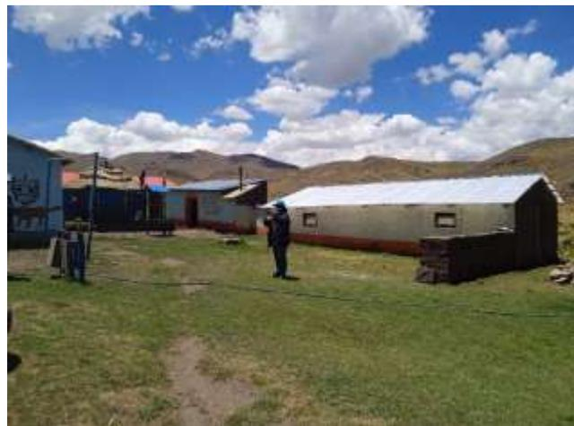
Módulo de invernadero construido con muros de adobe y pequeños vanos de ventilación y un techo a dos aguas con estructura de madera y recubierta por calaminas plásticas transparentes.
