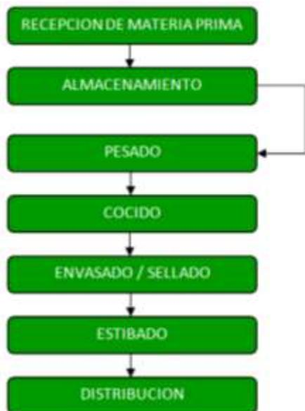
Figura 3. Flujograma del proceso para elaboración de bebida
