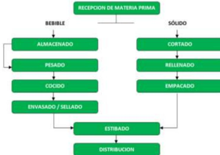
**Figura 3. Flujograma del proceso para preparación de desayuno: bebida y sólido**
